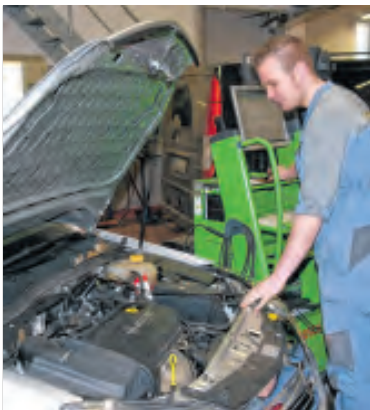
Eine moderne Werkstattausstattung gewährleistet im Autohaus Kahle optimalen Service. Dazu gehört auch eine fundierte, PC-gestützte Motordiagnose. Foto: Petra Ropers
